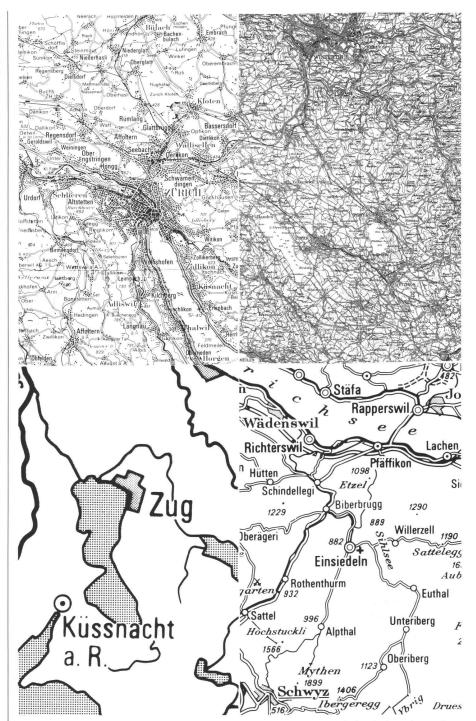
Abb.3 Wahl der zweckmässigsten Basiskarte. Alle 4 Kartenausschnitte haben den selben Massstab, nämlich 1:300 000. Sie passen genau zusammen und sind durch Vergrössern resp. Verkleinern verschiedener Landeskarten entstanden.
