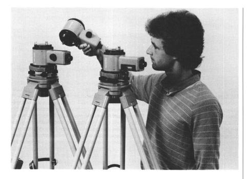
Das Wild ZNL wird in einem unverwüstlichen und wasserdichten Makrolon-Transportbehälter geliefert, in dem auch Dreifuss und Fadenkreuzbeleuchtung abschliessbar Platz finden. Für Hoch- und Tiefbau, Bergbau, Ingenieurbau, Landesvermessung und Industrie bietet dieses neue Instrument aus der Schweiz interessante Möglichkeiten. Es ergänzt das Wild-Programm der optischen Lotgeräte Wild ZL/NL, die mit ihrer Automatik auf ±0,5 mm/100 m die Vertikale bestimmen.
