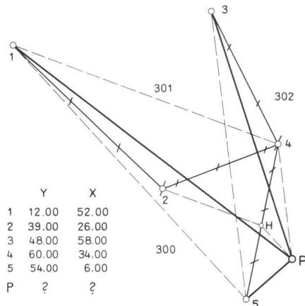
Bestimmung von H durch Abschiebung. H = Schnittpunkt 4-5 mit Parallele zu 1-4 durch 2. H = Y 56.851 X 19.306. Mit der prov. Grenze 1-H bleiben die Flächen von 300 und 301 unverändert.
