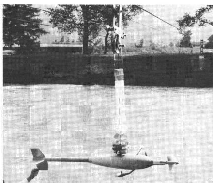
Die Abbildung zeigt die «Seilflügelanlage» der eidgenössischen hydrometrischen Station Thun. Der am Stromlinienkörper rechts angebrachte Messflügel dreht sich in der Strömung. Aus seinen Signalen, die über Kabel zum Rechner im Stationshäuschen übertragen werden, kann die Fließgeschwindigkeit bestimmt werden. Stabilisatoren (links) und Zusatzgewichte halten das Präzisionsinstrument im fließenden Wasser möglichst stabil an Ort.
