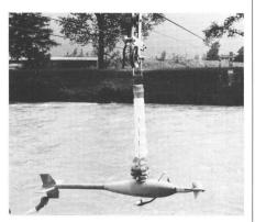
Die Abbildung zeigt die (Seilflügelanlage) der eidgenössischen hydrometrischen Station Thun. Der am Stromlinienkörper rechts angebrachte Messflügel dreht sich in der Strömung. Aus seinen Signalen, die über Kabel zum Rechner im Stationshäuschen übertragen werden, kann die Fliessgeschwindigkeit bestimmt werden. Stabilisatoren (links) und Zusatzgewichte halten das Präzisionsinstrument im fliessenden Wasser möglichst stabil an Ort.
