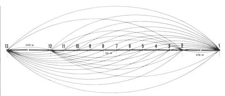
Fig. 6 Détermination de la constante du Terramètre sur la base.
