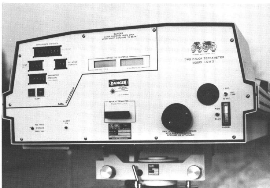
Fig. 3 Terramètre, panneau arrière.
