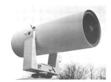
Fig. 5 Terramètre: Rétro-réflecteur.
