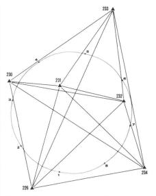
Fig. 7 Réseau test de trilatération.
