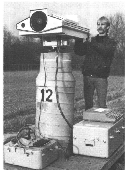
Fig. 4 Le Terramètre en station avec son imprimante.
