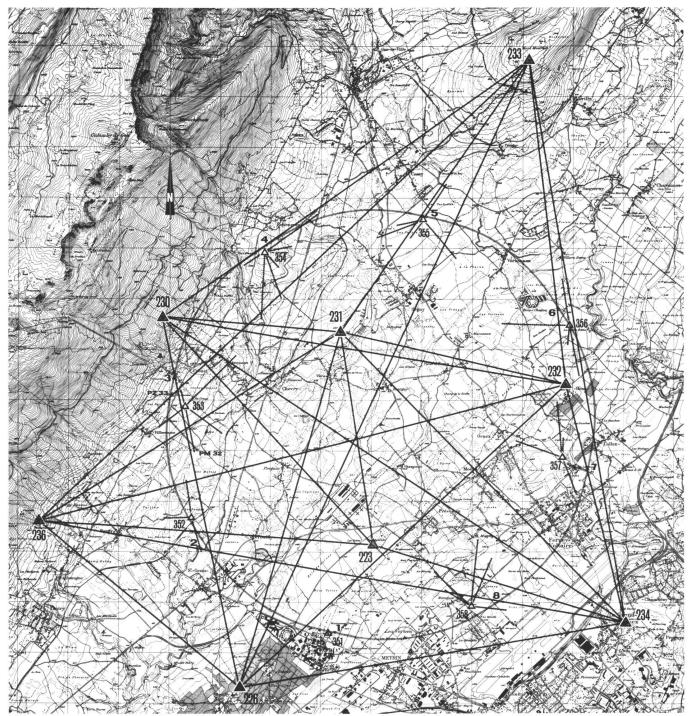
Fig. 8 Réseau de trilatération du LEP.
