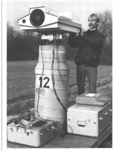
Fig. 4 Le Terramètre en station avec son imprimante
