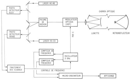
Fig. 2 Schéma de principe du Terramètre.
