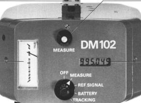
Starttaste (Dauer einer Messung: 8 Sekunden)
