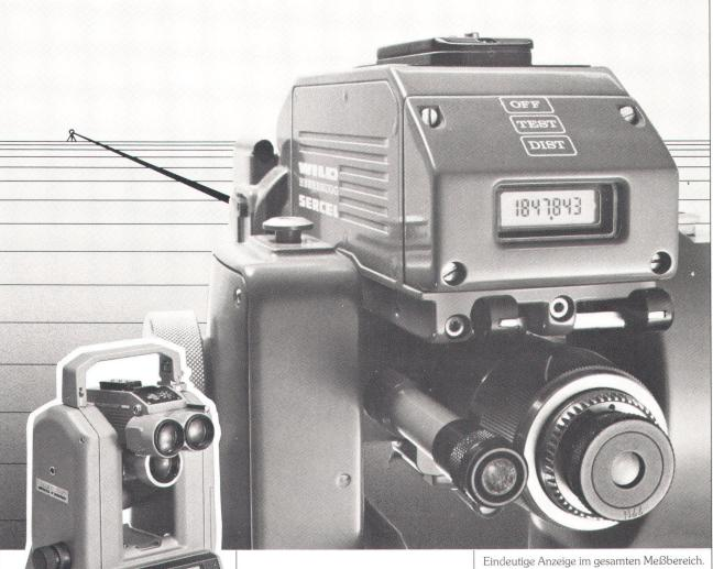
Der DISTOMAT Wild DI5 erweitert das führende Wild-Baukastensystem um ein handliches und besonders leistungsfähiges Modell: mit hoher Reichweite, beachtenswerter Genauigkeit von 3 mm + 2 mm/km und einem überdurchschnittlichen Bedienungskomfort.
