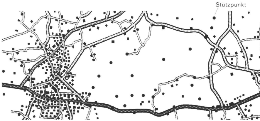
Abb. 9 Definition der Linienachsen neuer Strassen durch Stützpunktfolgen am Rasterbildschirm (aus [2]).
