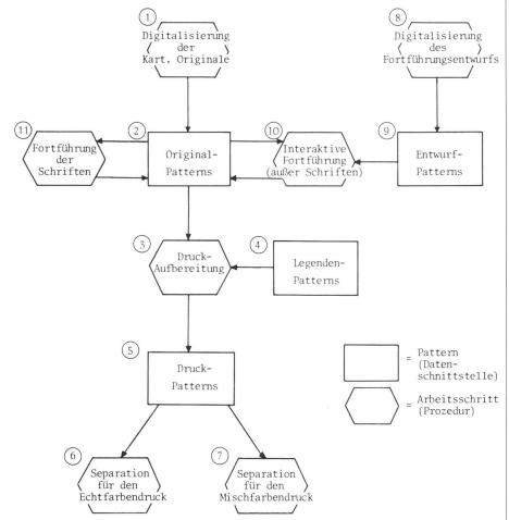
Abb. 8 Ablaufschema einer automationsgestützten Landkartenfortführung. (Der Begriff (Pattern) ist gleichbedeutend mit (digitale Rasterkarte), (Separation) bedeutet (Druckfolie).)
