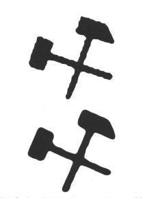
Abb. 6 Im digitalen Rastermodus von 32 Punkten/mm erzeugtes Kartensymbol auf dem Rasterplotter-Film (oben) und nach dem Offsetdruck (unten), etwa 35fach vergrössert.
