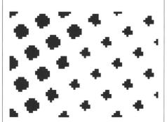
Abb. 5 Aufbau des autotypischen Rasterpunkts bei elektronischer Direktrasterung, links für einen höheren, rechts für einen geringeren Rastertonwert. Abstand der Rasterpunktmitten: vertikal 5, horizontal 10 Laserpunkte (aus [5]). Vergrösserung ca. 30fach.
