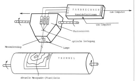
Abb. 3 Prinzipskizze eines Mehrfarben-Scanners (aus [5]).
