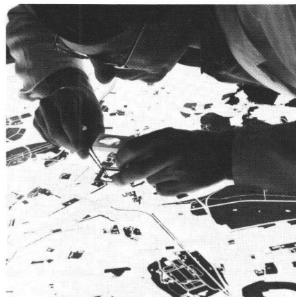
Abb.15b zeigt die Freilegung von Flächen mit der Pinzette aus der maschinell vorge-schnittenen Ablösefolie (Cut and Peel)
