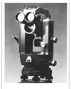
Im Wild DI5 spürt man die langjährige Erfahrung eines Pioniers im Bau von Infrarot-Distanzmessern, der auch heute mit dem etwas grösseren Distomatmodell DI20 den präzisesten und weitreichendsten Infrarot-Distanzmesser der Welt anbietet. Die Messprogramme des Wild DI5 laufen mit hoher Präzision und Zuverlässigkeit auf Tastendruck vollautomatisch ab. Die klare LCD-Anzeige zeigt die Distanz exakt an und schaltet bei Dunkelheit selbsttätig eine Anzeige-Beleuchtung ein.
