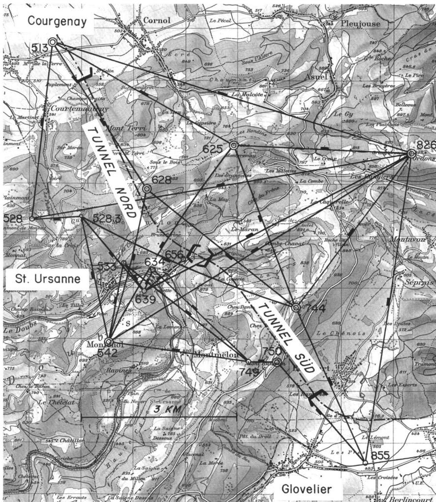
Abb. 6 Tunnelnetz Transjurane
