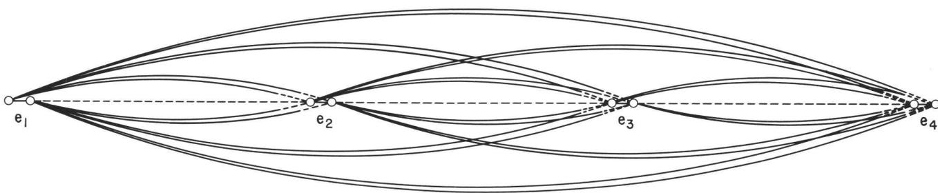
Abb. 4 Bestimmung der Additionskorrektur eines EDM-Gerätes mit Hilfe von drei unbekanntnen Teilstrecken
