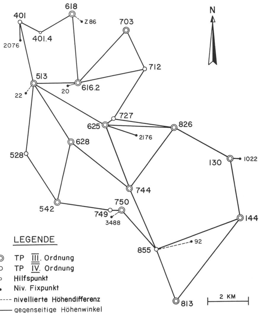
Abb. 5 Höhennetz zur Reduktion der EDM-Distanzen
