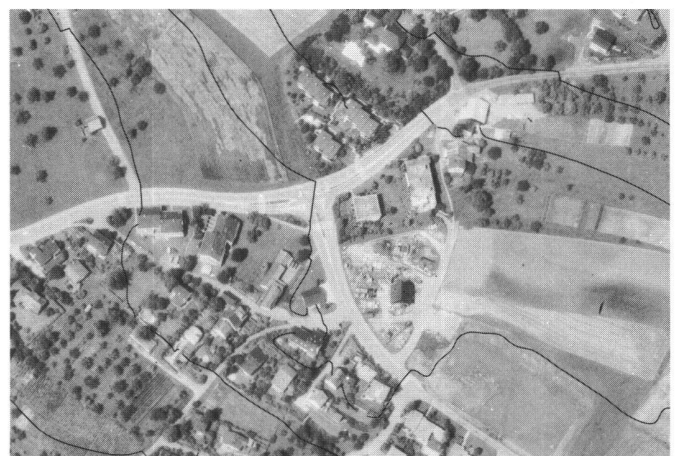
Abb. 7 Kombination des Orthophotos 1:5000 mit den Deckfolien Schrift, Parzellengrenzen und -nummern
