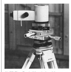
GMT5/ZL: Zwei Messtische können zu einem Kreuztisch kombiniert werden. Hier vereinfachen sie in einem Schacht die Deformationsmessung mit dem automatischen Zenitlot Wild ZL. Kleinste Verschiebungen in zwei zueinander senkrechten Achsen lassen sich so exakt bestimmen.
