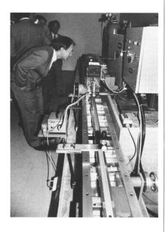
durch einen gepulsten Gaslaser erzeugt. Kalibrierungen der neuen Teilung haben gezeigt, dass die Genauigkeit innerhalb ±5 µm liegt. Weitere wesentliche Vorteile des neuen Verfahrens liegen darin, dass jeder beliebige Abstand und jede beliebige Strichform gewählt werden kann.
