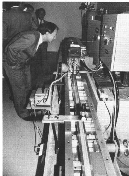
durch einen gepulsten Gaslaser erzeugt. Kalibrierungen der neuen Teilung haben gezeigt, dass die Genauigkeit innerhalb  $\pm 5 \mu$ m liegt. Weitere wesentliche Vorteile des neuen Verfahrens liegen darin, dass jeder beliebige Abstand und jede beliebige Strichform gewählt werden kann.
