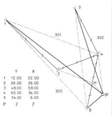
Bestimmung von H durch Abschiebung. H=Schnittpunkt 4–5 mit Parallele zu 1–4 durch 2. H=Y 56.851 X 19.306. Mit der prov. Grenze 1–H bleiben die Flächen von 300 und 301 unverändert.
