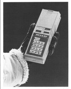
Das handliche, elektronische Datenterminal Wild GRE3 eignet sich besonders zur Erfassung, Verarbeitung, Speicherung und Ausgabe von Daten im Feldeinsatz – auch bei extremen Umweltbedingungen. Als Speichermedium dient ein Magnetblasenspeicher, in dem die Daten, auch nach dem Abschalten der Stromversorgung, erhalten bleiben.
