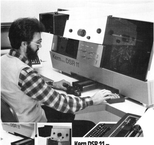
Bequeme Freihandführung für X-, Y- und Z-Bewegungen. Wahlweise werden auch X-, Y-Handräder, Z-Fussscheibe oder X-, Y-Trackball geliefert.
