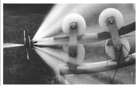
Abb. 6 Die Spüldüse des Homburg-Gerätes. Sehr schön erkennt man die für alle Düsen dieser Art typischen Wasserstrahlen (fünf nach hinten, einer nach vorne links gerichtet), dazwischen die im Text beschriebene Spiralfeder gegen das Steckenbleiben der Düse im Rohr. Rechts hinter der ersten Doppelrolle ist ein eingebautes Reparaturstück (Länge des Rollendurchmessers) zu sehen.
