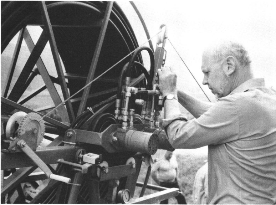
Abb. 5 Die Schalteinrichtung der Hydraulikanlage am Gerät «Junior» von Homburg. Links unter der Drehachse der Schlauchtrommel erkennt man das weiße Kästchen des Meter-Zählwerkes.
