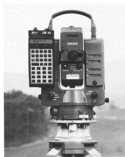
Abb.2 Unser Gerätesystem im Dienste Ihres Taschenrechners. Kern E 2/DM 503 Tachymeterkombination mit Dateninterface Kern DIF 41 und Taschenrechner HP-41C/CV
