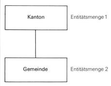
Abb. 3 Darstellung einer Beziehung zwischen zwei Entitätsmengen
