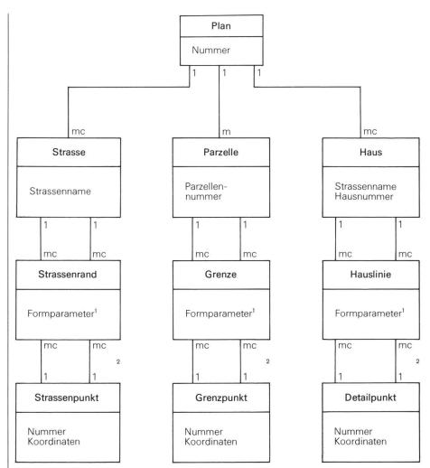
Abb. 17 Beispiel für ein Entitätenblockdiagramm zu Abb. 16
