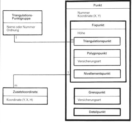
Abb. 15 Entitätenblockdiagramm mit Generalisierung
