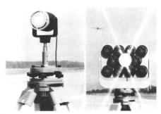
Wild GEB 72: Links: der Zielscheinwerfer Wild GEB 72, in zwangszentrierter Aufstellung, als gut sichtbarer Zielpunkt auf Reflektorträger GRT 10, eingesetzt im Einprismenhalter GPH 1 anstatt eines Einerprismas. Rechts: eingesetzt in den Elfprismenhalter GPH 11, macht der neue Zielscheinwerfer den Zielpunkt bei Distanzmessungen über grosse Entfernungen sofort sichtbar. Er wird hier anstatt eines Einerprismas in die Mitte eingesetzt.
