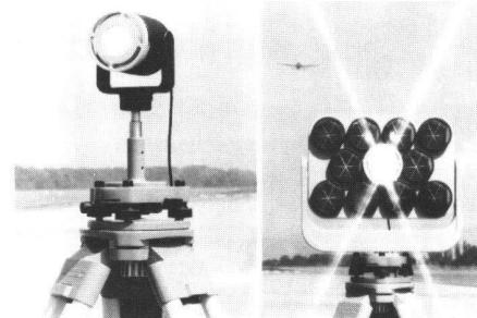
Wild GEB 72: Links: der Zielscheinwerfer Wild GEB 72, in zwangzentrierter Aufstellung, als gut sichtbarer Zielpunkt auf Reflektorträger GRT 10, eingesetzt im Einprismenhalter GPH 1 anstatt eines Einerprismas. Rechts: eingesetzt in den Elfprismenhalter GPH 11, macht der neue Zielscheinwerfer den Zielpunkt bei Distanzmessungen über grosse Entfernen sofort sichtbar. Er wird hier anstatt eines Einerprismas in die Mitte eingesetzt.
