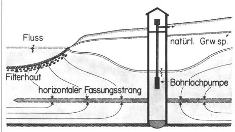
Schematische Darstellung der Gewinnung von Uferfiltrat
