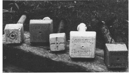
Sortiment der im Kanton Thurgau verwendeten Marken, von links nach rechts: Frings, mit Stahlrohrschaft; Klarer, Vollpolyester; Attenberger, Stahlrohr mit Spindel; Klarer;
