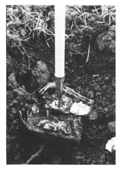
Abb. 3 Abgeschlagener Kopf einer Marke mit Stahlrohrschaft
