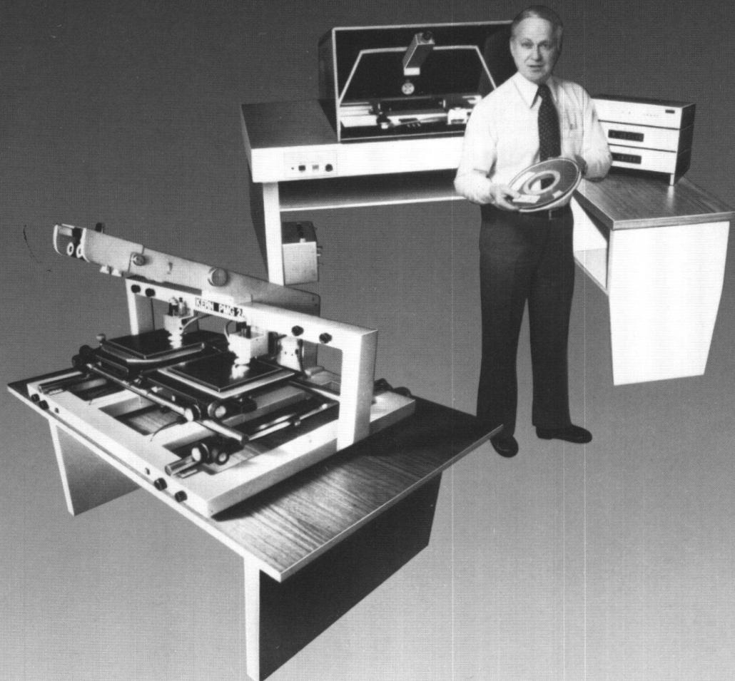
**PMG 2** Ein Zoom-Punktübertragungsgerät mit dem endlich eine Übertragungsgenauigkeit von wenigen  $\mu$  erreicht wird, eine Voraussetzung für die modernen Mess- und Rechenmethoden in der analytischen Aerotriangulation.
