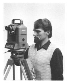
Abb.3 Am zentralen Anzeigefeld des Theomat werden auch in der höchsten Ausbaustufe (T2000/DI4/GRE3) sämtliche Funktionen überwacht und gesteuert.
