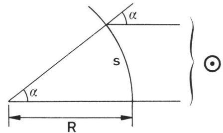
Gemessen: der Zentriwinkel  $\alpha$ . Beobachtungsgleichung:  $R\alpha = s$ , oder  $\ln R + \ln \alpha = \ln s$ , (mit  $R$  = Erdradius,  $s$  = Bogenlänge des Kreissektors). Fehlergleichung:
