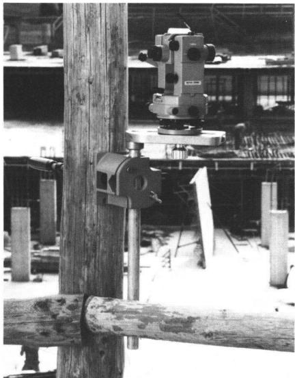
Problemlose Instrumentenaufstellung an Gerüsten, Maschinen, Wänden und an der Decke ermöglicht das neue Klemmstativ Wild GST9. Die beiden Teile lassen sich verschieden kombinieren und gestalten eine optimale Instrumenten-Aufstellung auch unter extrem beanspruchten Verhältnissen sowie für Spezialmessungen aller Art.
