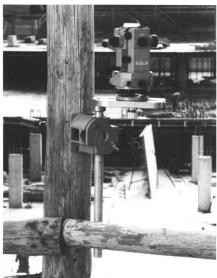
Problemlose Instrumentenaufstellung an Gerüsten, Maschinen, Wänden und an der Decke ermöglicht das neue Klemmstativ Wild GST9. Die beiden Teile lassen sich verschieden kombinieren und gestatten eine optimale Instrumenten-Aufstellung auch unter extrem beengten Verhältnissen sowie für Spezialmessungen aller Art.
