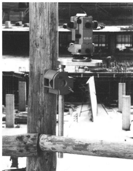
Problemlose Instrumentenaufstellung an Gerüsten, Maschinen, Wänden und an der Decke ermöglicht das neue Klemmstativ Wild GST9. Die beiden Teile lassen sich verschieden kombinieren und gestalten eine optimale Instrumenten-Aufstellung auch unter extrem beengten Verhältnissen sowie für Spezialmessungen aller Art.
