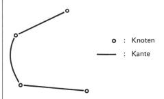
Abb. 2 Geometrische Primitive: Knoten, Kanten
