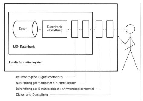
Abb. 5 Schichten in Landinformationssystemen
