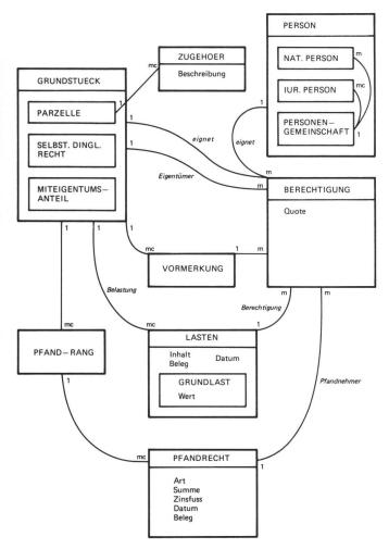
Abb.10 Modell für die Erfassung des Grundbuches
