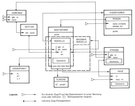
Abb. 4 Beispiel eines Entitäten-Blockdiagramms
