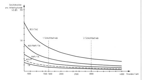
Abb. 2 Gerätekosten in Funktion von der Auslastung.
