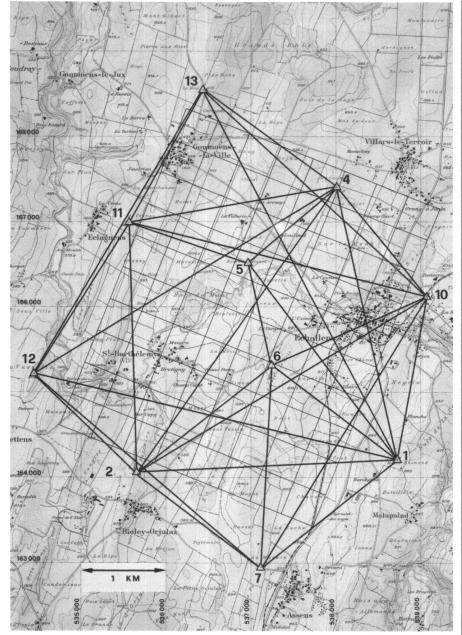
Fig. 1 Schéma du réseau géodésique de base du champ d'essai d'Echallens. Le quadrillage, avec une maille de 400 m, indique la position idéale des prises de vue photogrammétriques. (Extrait de la carte nationale 1: 25 000, reproduit avec l'autorisation de l'Office fédéral de Topographie du 17.2.83.)
