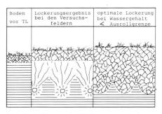
Abb. 7 Wirkung der Tieflockerung bei verschiedenem Wassergehalt.
