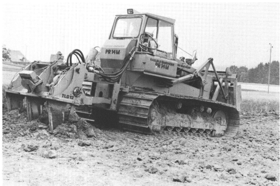
Abb.1 Der dreischarige Stechhublocker TLG12, der bei der Lockerung der Versuchsfelder zum Einsatz kam.
