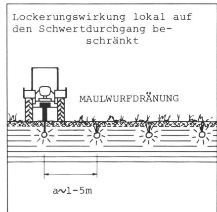
Abb. 8 Wirkung der Maulwurfdrainage im staunassen, plastisch verformbaren Boden.
