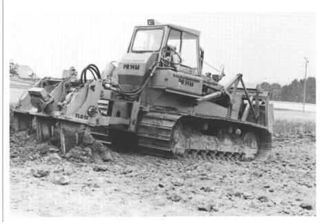
Abb.1 Der dreischarige Stechhublockerer TLG12, der bei der Lockerung der Versuchsfelder zum Einsatz kam.
