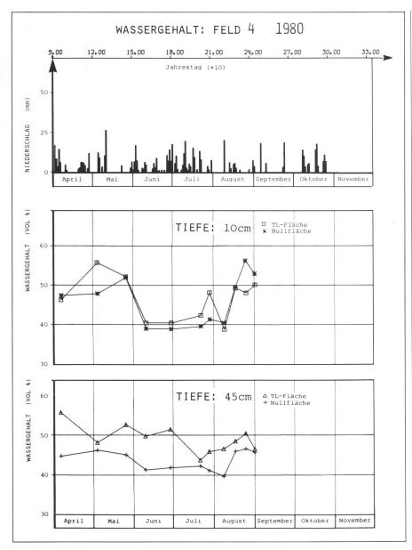
Abb. 3 Wassergehaltsmessungen auf dem Feld 4 im Jahr 1980. Die gelockerte Fläche weist in der Tiefe von 45 cm einen signifikant höheren Wassergehalt auf.
