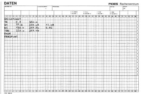
Abb. 3 Koordinaten der Knickpunkte im Längenprofil (Fides)
