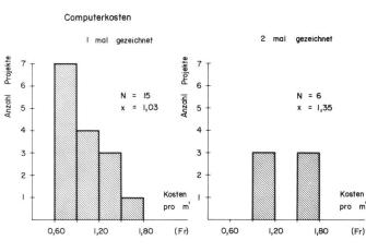
Abb. 11 Computerkosten pro Laufmeter Strasse bei einmaliger respektive zweimaliger Zeichnung
