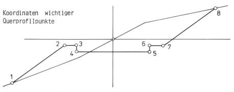
Abb. 4 Massgebende Querprofilpunkte für die Massenberechnung
