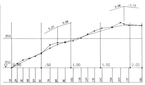
Abb. 6 Plotterzeichnung: Längenprofil mit Terrainlinie und Gradiente (Fides)
