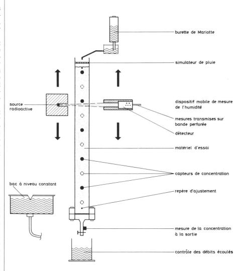
Fig.1 Schéma du dispositif expérimental de laboratoire
