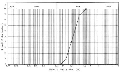
Fig. 2 Courbe granulométrique du matériel de laboratoire
