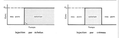
Fig. 4 Différentes conditions d'injection
