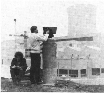
Abb. 3 Kontrolle des geodätischen Grundlagennetzes mit dem KERN-Mekometer ME 3000. Im Hintergrund das Reaktorgebäude und der Kühlturm (Foto: E. Brügger).
