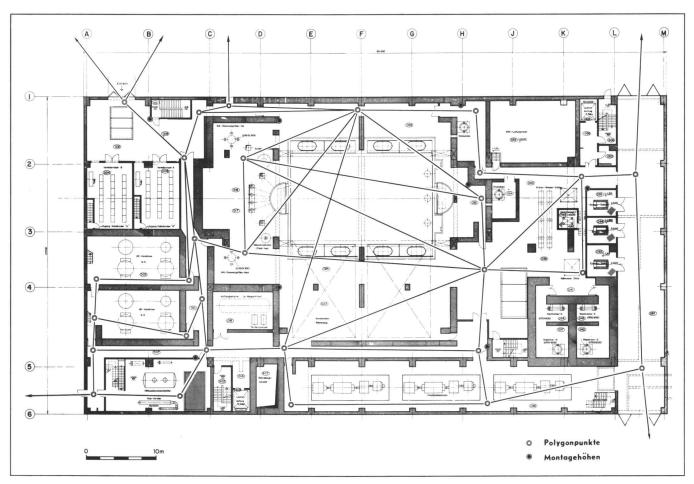
Abb. 5 zeigt das Polygonat und die Montagehöhen im Maschinenhaus auf Kote ±0 m. Für die Bestimmung der 29 Polygonpunkte wurden 107 Distanzen mit dem KERN-Mekometer ME 3000 oder mit der 1-m-Invarbasislatte und 122 Richtungen mit dem Theodolit KERN DKM 2AE gemessen (Reproduktionsbewilligung durch BBC im September 1982).
