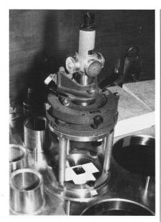
Abb. 9 Optisches Fluchtfernrohr Taylor Hobson, montiert auf Lotungsgerät Keuffel & Esser, mit Kreuzschlitten fixiert in einer Bohrung der Core plate.
