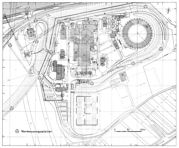
Abb. 2 Gesamtübersicht der Anlage mit den 14 Vermessungspfeilern.
