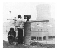
Abb. 3 Kontrolle des geodätischen Grundlagennetzes mit dem KERN-Mekometer ME 3000. Im Hintergrund das Reaktorgebäude und der Kühlturm (Foto: E. Brügger).
