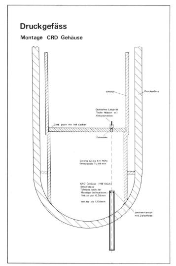
Abb. 8 Geodätisches Messprinzip bei der Kontrolle der CRD-Gehäuse im Druckgefäss.
