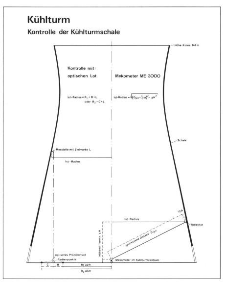
$\mbox{Abb.4}$  Kontrolle der Kühlturmschale mit den beiden Messmethoden, optische Lotung und Mekometer ME 3000.
