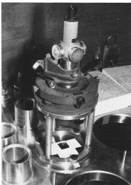
Abb.9 Optisches Fluchtfernrohr Taylor Hobson, montiert auf Lotungsgerät Keuffel & Esser, mit Kreuzschlitten fixiert in einer Bohrung der Core plate.
