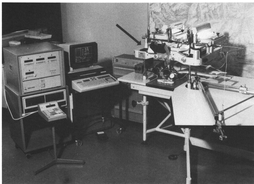
Fig. 8 Superposition des photographies aériennes vues dans les oculaires d'un stéréorestituteur (Kern PG2) avec l'image affichée sur écran graphique (Hewlett-Packard 9845B). Cette superposition a été réalisée à l'aide d'un miroir semi-argenté et d'un objectif monté à côté des oculaires (cf. flèche).
