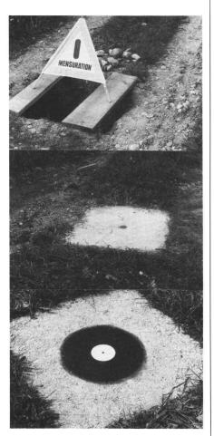
Fig. 2 Afin de garantir une stabilité des points dans l'ordre des millimètres, les points fixes ont été matérialisés dans le terrain ouvert par des blocs de béton d'une taille de 80 x 80 x 80 cm. Le point de mesure propre est fixé par une cheville. Pour la signalisation, on a eu recours à des couleurs, le centrage a été assuré par des chablons.
