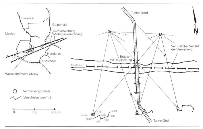
Abb. 6 Hauptverwerfungen Guatemalas, Deformationsmessungsanordnung, Relative Verschiebungen der beiden Talseiten
