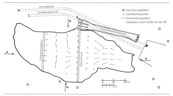
Abb. 4 Damm, Situation: Horizontalverschiebungen der Oberflächenpunkte
