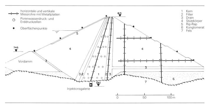
Abb. 3 Längsschnitt A-A durch den Dammkörper mit Instrumentierung: Messrohre, Porenwasser- und Erddruckzellen, Oberflächenpunkte
