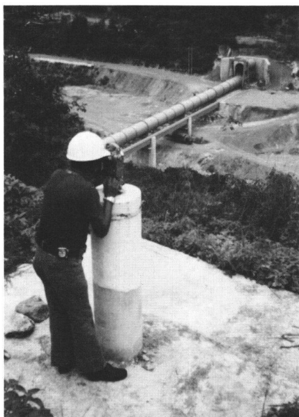
Abb. 7 Arbeit am Vermessungspfeiler
