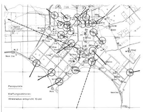
Abb. 6 Passpunkte für die Positionierung des Netzes, sowie Klaffungsvektoren; 3 Punkte sind offensichtlich zu eliminieren; der Massstab differiert um ca.  $5\,\mathrm{cm}/100\,\mathrm{m}$
