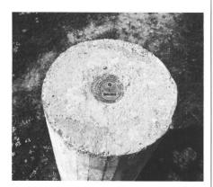
Abb. 2 Triangulationspunkt in Form eines Betonpfeilers; Text auf der Plakette: (Geographischer Dienst der Armee – Trigonometrisches Netz – 1969)
