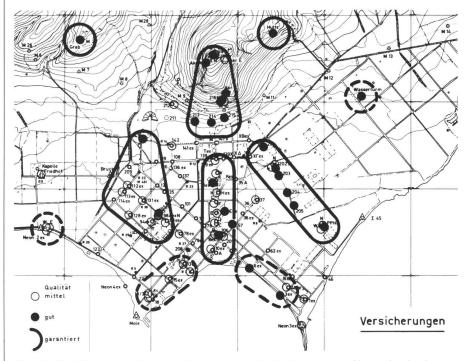
Abb.3 Die Lösung des Hauptproblems: der langfristige Bestand des Netzes ist durch symmetrisch verteilte Punkträume und Punktgruppen gewährleistet, in denen jeweils einige Punkte genügend zuverlässig versichert sind
