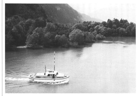
Abb.1 Das Vermessungsschiff (Explorer) im Einsatz auf dem Walensee. Die Wassertiefe wird mit einem Ultraschall-Echolot kontinuierlich gemessen und aufgezeichnet. Die Positionsbestimmung des Schiffes erfolgt mit Hilfe von Laser- und Radiowellen ebenfalls kontinuierlich von einer Landstation aus; alle Messwerte werden im Bord-Computer verarbeitet.
