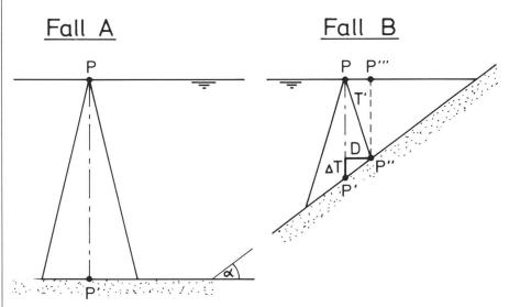
Abb. 4 Infolge der kegelförmigen Ausbreitung des Echolot-Schallsignals entsteht bei geneigtem Seegrund ein systematischer Tiefen-Messfehler  $\Delta T$ , weil das zuerst eintreffende Echosignal von Punkt P" stammt, welcher aber nicht senkrecht unter der gleichzeitig eingemessenen Position P des Messschiffs liegt. Weitere Erläuterungen im Text.
