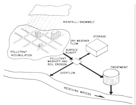
Abb. 3 Schema eines zu modellisierenden Einzugsgebietes – Stufe Planung (D. F. Kibler, Urban Stormwater Hydrologie, 1982).
