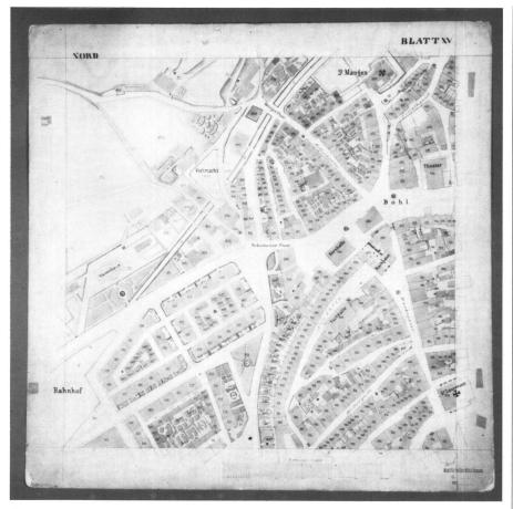
Abb.1 Das Planwerk der ersten amtlichen Vermessung bestand aus 42 Messtischblättern, Format  $53 \times 53$  cm. Das Bild zeigt das Blatt XV.
