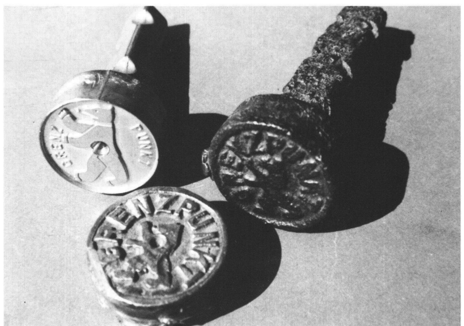
Abb. 2 Alter und neuer Grenzbolzen.
