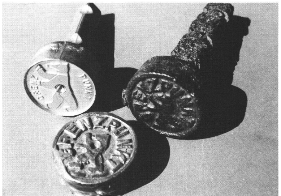
Abb. 2 Alter und neuer Grenzbolzen.
