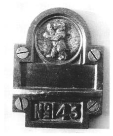
Abb. 4 Eine der 180 Höhenfixpunkttafeln der Neuvermessung 1883–1894.
