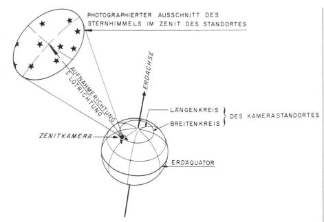
Abb. 3 Zum Prinzip der Sternfotografie mit Zenitkameras
