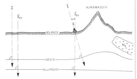
Abb.1 Die Existenz des Alpenmassivs und einer Störungsmasse  $M_{\text{S}}$  bewirkt nach dem Gravitationsgesetz eine Lotabweichung  $\epsilon$ .
