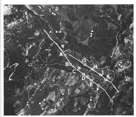
Fig. 1 Extrait d'une prise de vue aérienne de la région de (La Frasse). La zone de glissement principale est délimitée par la ligne traitillée. Les triangles indiquent les points de référence considérés comme stables. Ces points ont servi de points de calage pour la transformation des mesures des différentes années. Les lignes polygonales avec les points A–K indiquent la position des profils sur la figure 4.
