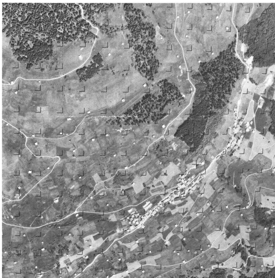
Abb. 2 Luftbild, überlagert mit projektiv verzerrtem Stichprobenraster (Punktabstand = 100 Meter, Originalmassstab des Luftbildes ca. 1:25 000, 2fach vergrössert). Für die Darstellung der Stichprobenpunkte wird ein Winkel von 25 Metern Schenkellänge verwendet, massgebend für die Bestimmung der Landnutzung ist der Eckpunkt. (Aufnahme des Bundesamtes für Landestopographie).
