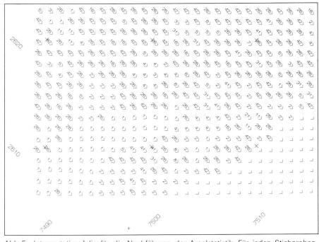
Abb. 5 Interpretationsfolie für die Nachführung der Arealstatistik. Für jeden Stichprobenpunkt ist der Nutzungscode der früheren Erhebung angegeben. Die Folie wird den Luftbildern überlagert, und der Bearbeiter überprüft für jeden Stichprobenpunkt, ob eine Änderung der Nutzung stattgefunden hat.
