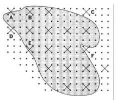
Abb. 5 Ermittlung der Kreuzdifferenz zur Beschreibung der Korrelation bei Stichprobenerhebungen mit einem regelmässigen Punktraster. Dazu wird dem Stichprobenpunkt der Wert eins zugewiesen, falls dieser auf das betreffende Merkmal (umfahrene Zone) fällt, und null, falls er ausserhalb zu liegen kommt. Die Kreuzdifferenz (vgl. Formel 5) wird dann für die Quadrupel A, B und C gleich null, für D und E gleich eins, und für F nimmt es den Wert zwei an.
