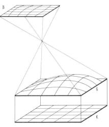
Abb.1 Übertragung eines regelmässigen Stichprobenrasters in ein Luftbild. Neben den Orientierungselementen des Luftbildes sind für die lagerichtige Lokalisierung der Stichprobenpunkte auch die Geländehöhen zu berücksichtigen. In der Darstellung bedeuten B die Bildebene, K die Kartenebene und G das Gelände.
