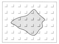
Abb. 4 Flächenbestimmung mittels eines regelmässigen Stichprobenrasters. Der zu erhebende Flächenanteil mit  $n_M = 10$  Stichprobenpunkten wurde gerastert und könnte eine Waldfläche darstellen. Auf den Gesamtperimeter entfallen  $n_G = 48$  Stichprobenpunkte.
