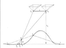
Abb. 3 Lagefehler, bedingt durch die Höheninterpolation. Eine lineare Interpolation zwischen den Punkten 1 und 2 führt zu einer Zunahme der Höhe des Punktes P um  $\Delta$ H. Dieser Höhenfehler beeinflusst die Lagegenauigkeit von Stichprobenpunkten bei einem Nachführungsflug. Der Lagefehler  $\Delta$ s entspricht dem ursprünglichen Höhenfehler  $\Delta$ H, reduziert um den Faktor s/hg (s = Abstand zwischen den Aufnahmestandorten der Bilder A und B, hg = Flughöhe über Grund).
