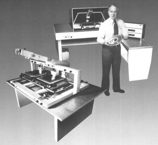
PMG 2 Ein Zoom-Punktübertragungsgerät mit dem endlich eine Übertragungsgenauigkeit von wenigen µ erreicht wird, eine Voraussetzung für die modernen Mess- und Rechenmethoden in der analytischen Aerotriangulation.
