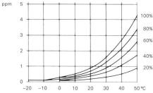
Abb. 2 Korrektur infolge des Partialdruckes des Wasserdampfes (z.B. Korrektur gleich – 1 ppm bei 60% relativer Feuchtigkeit und 31°C)
