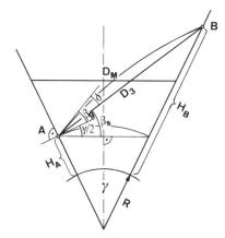
Abb. 9 Reduktion über Höhenwinkel
