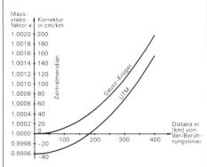
Abb.14 Projektionsverzerrung für Gauss-Krüger und UTM
