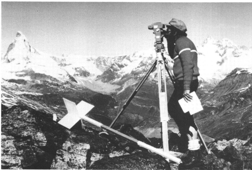
Abb. 2 Mit dem Wild-DI 4L werden die ca. 20 Passpunkte für die Luftbildauswertung am Findelengletscher vermessen.
