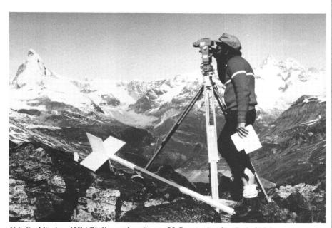
Abb. 2 Mit dem Wild-DI 4L werden die ca. 20 Passpunkte für die Luftbildauswertung am Findelengletscher vermessen.
