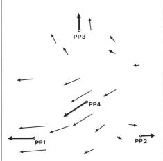
Abb. 3 Gegebene Inkremente für die Passpunkte und interpolierte Werte für die Zwischenpunkte
