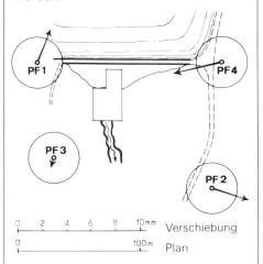
Abb.1 Restfehler bei der üblichen Helmert-Transformation
