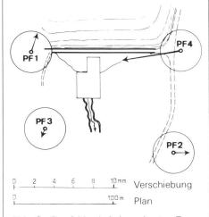
Abb. 2 Restfehler bei der robusten Transformation (k=2)
